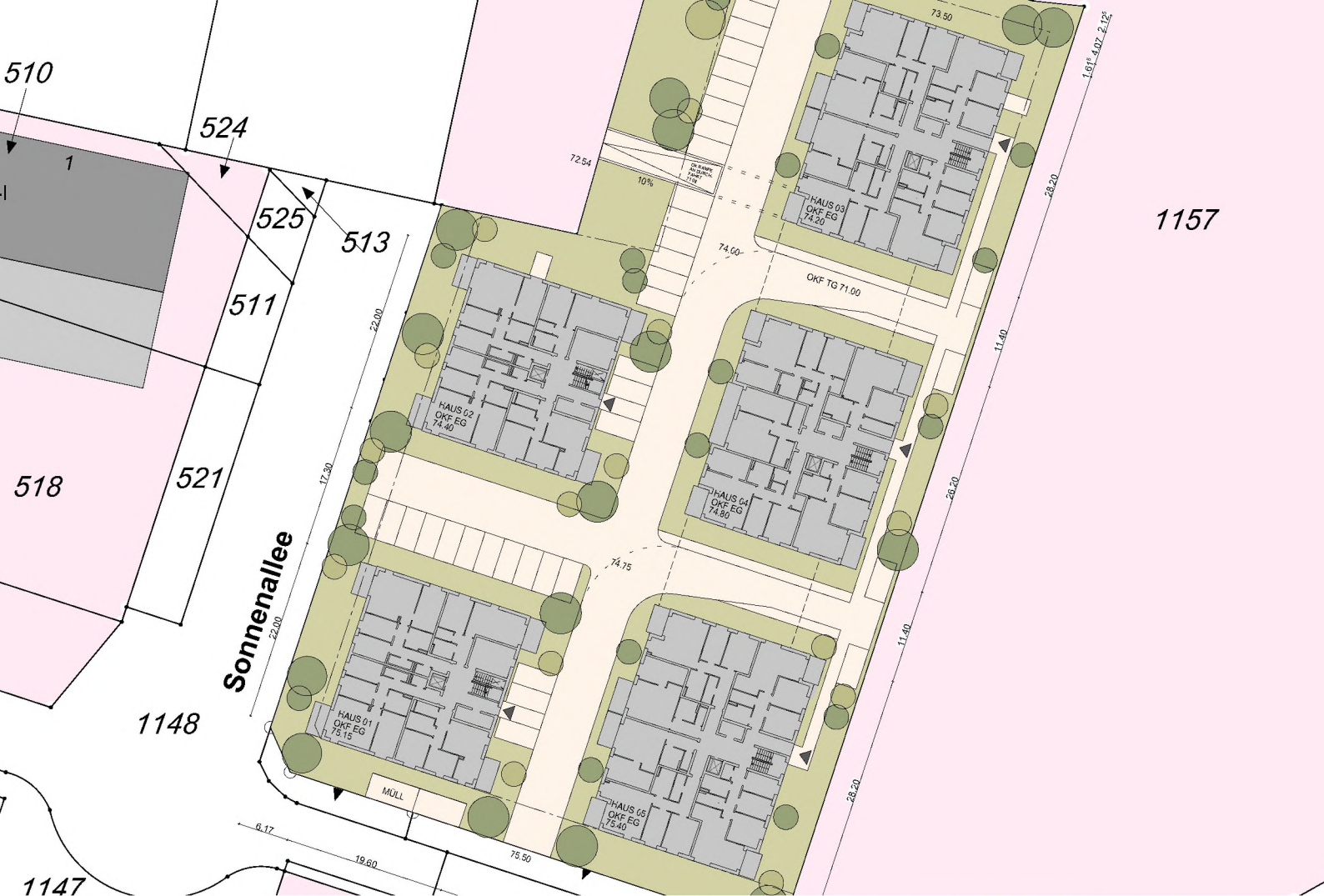
Bernau (Brandenburg), Sonnenallee, Beplanung eines Grundstücks im Rahmen der Festsetzungen eines B-Planes mit 5 Geschosswohnbauten und zugehörigen Außen- und Stellplatzanlagen, ca. 90 Wohnungen, ca. 8.000 m 2 , Planung der Gebäude, 2023/ 2024
